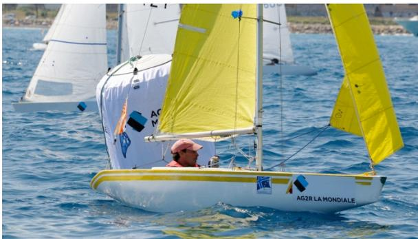
Le Miniji a été conçu il y a 30 ans pour l'entraînement au "Match Racing" qui est la plus ancienne formule de régates, celle de l'America's Cup. Réplique au 1/7<sup>e</sup> des classiques Classe J, il mesure 3,65 m. C'est un "quillard de sport" inchavirable et insubmersible qui permet à son pilote calé dans un siège face à la marche du voilier d'avoir toutes les commandes à portée de main. Le gouvernail est adaptable, pédalier ou volant selon les besoins de chacun.
